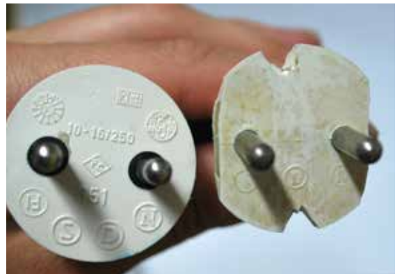
Kuvassa vasemmalla usein vanhoista sähkölaitteista löytyvä pistotulppa, joka ei mahdu nykyisiin pistorasioihin. Itse pistorasiaan sopivaksi tuunattu pistotulppa (oikealla) on erittäin vaarallinen.
