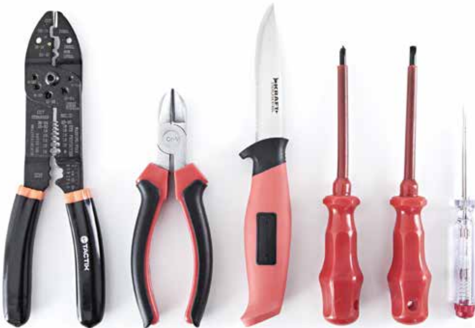
Kodin sähkötöihin tarvittavia työkaluja, kuvassa vasemmalta johtojen kuorimispihdit, sivuleikkurit, puukko, ristipääruuvimeisseli, ruuvimeisseli sekä jännitteenkoetin. Sähköjohdon vaipan kuorinta onnistuu joko puukolla tai vaipan kuorimispihdeillä.
